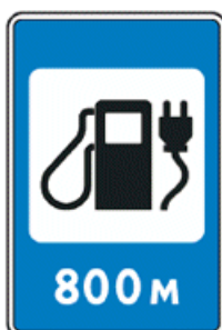
7.21 Автозаправочная станция с возможностью зарядки электромобилей
